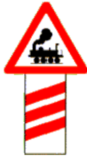
無柵門鐵路平交 道第一面
