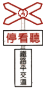
單線電化 鐵路平交道
